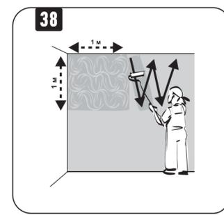
Повторяя действия 33-37, нанесите следующий участок с небольшим нахлестом, а затем таким же способом нанесите материал на всю поверхность.
