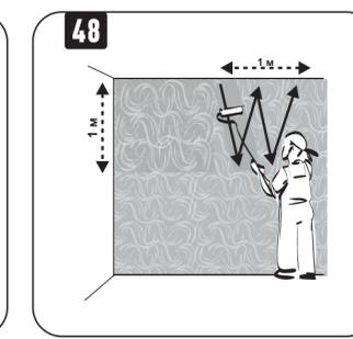
Повторяя действия 43-47, нанесите следующий участок с небольшим нахлестом на первый, а затем таким же способом нанесите материал на всю поверхность.
