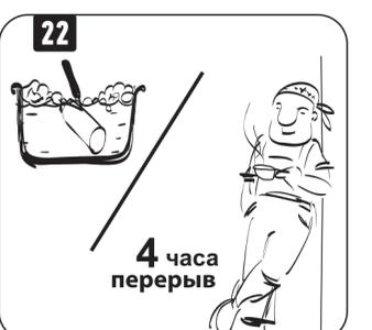
Тщательно вымойте валик теплой водой с мылом. Время высыхания 4 часа.
