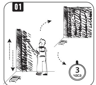
Медленно прокатывайте **ВАЛИК №1** вверх вниз от потолка до пола, разравнивая грунтовку и равномерно пропитывая поверхность. Нанесите грунтовку таким образом на всю поверхность. Время высыхания 3 часа.
