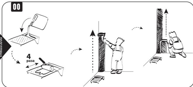
Возьмите канистру с грунтовкой. Встряхните 10 раз. Откройте крышку и налейте грунтовку в лоток для краски. Окуните **ВАЛИК №1** в лоток и прокатайте его 4 раза, смачивая в грунтовке. Прижмите валик к поверхности стены около пола и медленно прокатите его вверх до потолка, оставляя ровную мокрую полосу на стене. Перенесите валик вниз и прижмите к поверхности стены рядом с мокрой полосой, заходя на нее на 5 см и медленно прокатите вверх до потолка.
