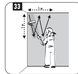
Нанесите материал толстым слоем в верхнем левом углу буквой W на участок высотой и шириной 1 м. Раскатывайте краску, плотно укрывая поверхность.
