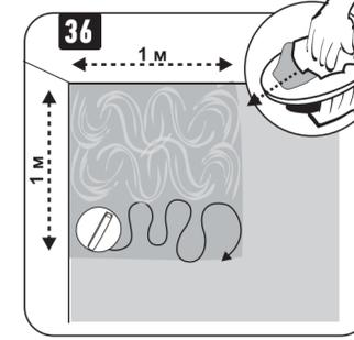
Еще раз очистите шпатель. Следующую полосу обрабатывайте слева направо, и так далее пока не нанесете рисунок на весь участок.
