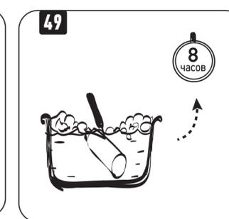
Тщательно вымойте валик теплой водой с мылом. Время высыхания материала 8 часов.
