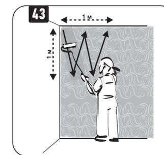
Нанесите материал в верхнем левом углу буквой W на участок высотой и шириной 1 м. Раскатывайте краску, плотно укрывая поверхность.
