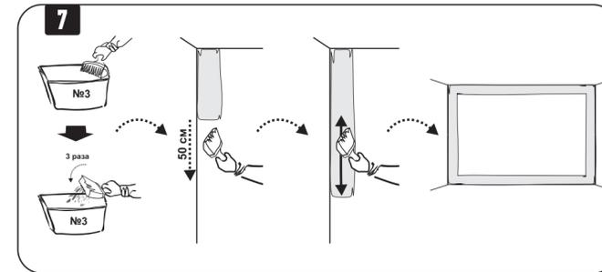
Повторяя действия 3-6, нанесите полосу краски на следующий участок вдоль угла, а затем на все примыкания к стенам, потолку и полу.
