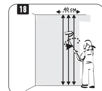
Еще раз разверните валик и, двигаясь от угла, прокатывайте вверх-вниз, разравнивая краску. Тщательно прокрашивайте примыкания к полу и потолку.
