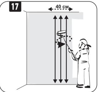
Разверните валик и прокатайте вверх-вниз, разравнивая краску и закрывая поверхность. Тщательно закрасьте примыкание к предыдущей полосе.
