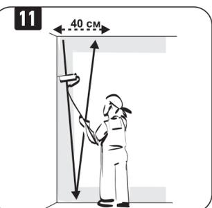
Прижмите валик к стене в левом верхнем углу и нанесите краску от потолка до пола и обратно полосой в форме буквы V шириной 40 см.
