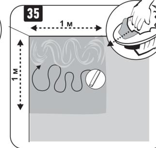
Очистите шпатель ветошью. Нанесите рисунок, двигая шпатель сложной змейкой справа налево.
