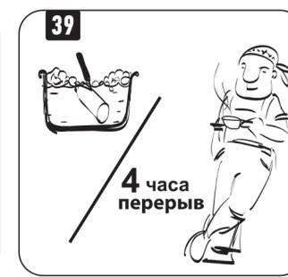
Тщательно вымойте валик теплой водой с мылом. Время высыхания 4 часа.
