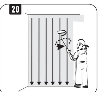
Разверните валик и, начиная с ранее нанесенной полосы, прокатывайте без нажима сверху вниз, окончательно заглаживая поверхность.
