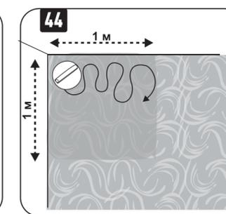
Прижмите ШПАТЕЛЬ №3 плоскостью к поверхности, нанесите рисунок, двигая шпатель извилистой змейкой слева направо, оставляя за ним тонкие следы.
