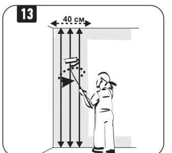
Еще раз разверните валик и, двигаясь от угла, прокатывайте вверх вниз, разравнивая краску. Тщательно прокрасьте примыкания к полу и потолку.
