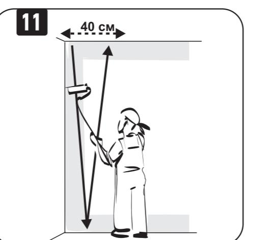
Прижмите валик к стене в левом верхнем углу и нанесите краску от потолка до пола и обратно полосой в форме буквы V шириной 40 см.
