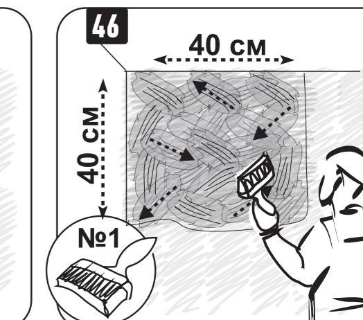
Обработайте поверхность КИСТЬЮ №1 короткими мазками в разные стороны, чтобы полностью укрыть поверхность перламутром.
