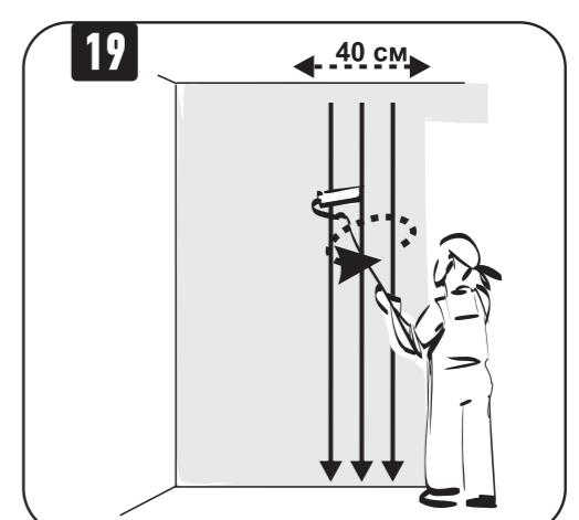
Еще раз разверните валик и прокатывайте без нажима сверху вниз, окончательно заглаживая поверхность. Прокатайте ранее нанесенную полосу таким же способом.
