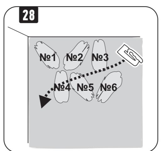
Прижмите шпатель к поверхности в правом верхнем углу нанесенного участка и загладьте рисунок длинным волнообразным движением с сильным нажимом.
