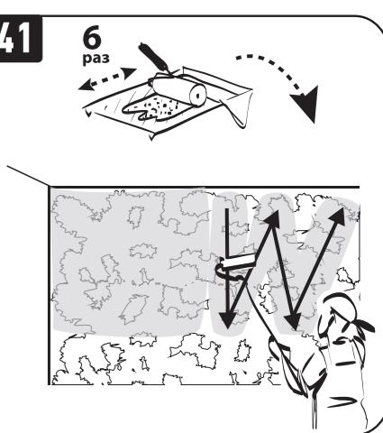
Повторяя действия 37-40, нанесите краску на следующий участок, а затем на всю поверхность.
