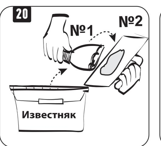
Положите смесь из большого ведра с помощью ШПАТЕЛЯ №1 на середину ШПАТЕЛЯ №2, как на рисунке.
