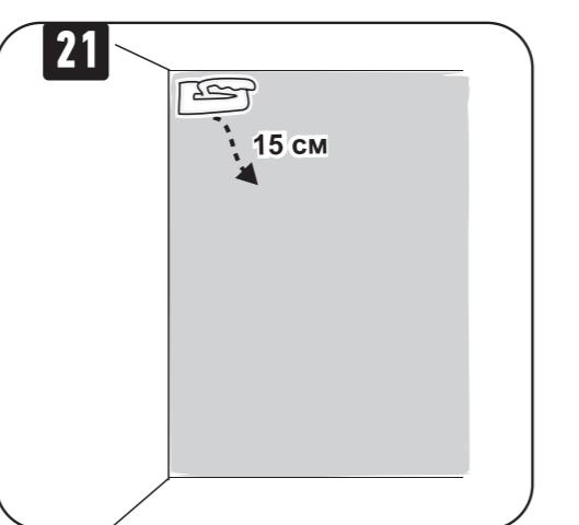
В левом верхнем углу прижмите с небольшим нажимом шпатель к поверхности и нанесите мазок вниз и вправо длиной 15 см.
