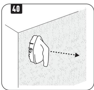
В левом верхнем углу прижмите **щетку** к поверхности стены без нажима и затем оторвите, оставляя аккуратные пятнышки материала.
