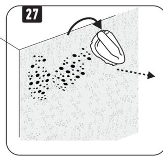
Еще раз немного поверните щетку и снова прижмите рядом с предыдущим пятном. Оторвите инструмент от поверхности.
