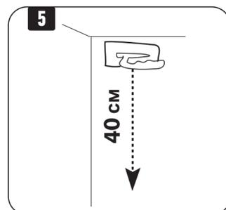
Сильно нажимая на шпатель, нанесите в левом верхнем углу от потолка вниз мазок длиной 40 см.
