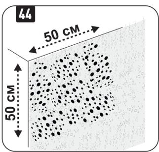
Нанесите материал на поверхность, до тех пор пока не покроете рисунком из аккуратных пятен участок 50 на 50 см.
