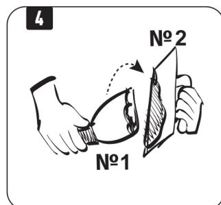
Положите смесь из ВЕДРА №3 с помощью ШПАТЕЛЯ №1 на кромку ШПАТЕЛЯ №2.
