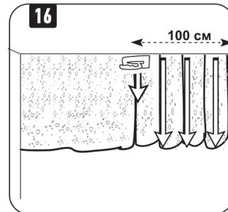
Протрите ШПАТЕЛЬ №2 ветошью. Сильно прижимая его к поверхности заглаживайте и разравнивайте материал движениями сверху вниз, до тех пор пока не получите ровную поверхность без следов от шпателя.
