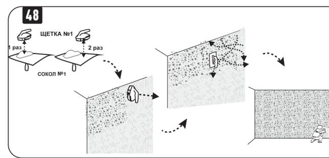
Повторяя действия 38-47, нанесите рисунок на следующий участок, а затем на всю поверхность.
