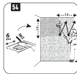
Повторяя действия 51- 53, нанесите материал на следующий участок, а затем на всю поверхность.
