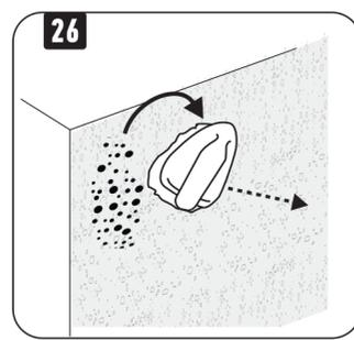
Немного поверните щетку и снова прижмите ее без нажима к поверхности рядом с предыдущим пятном. Оторвите инструмент от поверхности.
