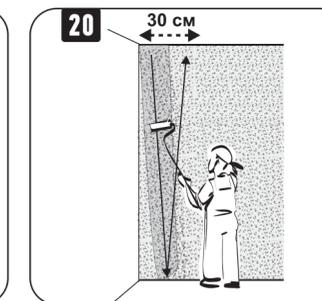
Прижмите валик к стене в левом верхнем углу и нанесите краску от потолка до пола и обратно полосой в форме буквы V шириной 30 см.
