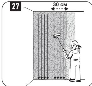
27 Прокатайте валиком сверху вниз на всю высоту стены обе нанесенные полосы, разравнивая покрытие.
