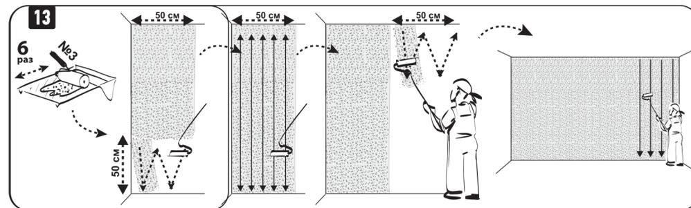
Повторяя действия 5-12, нанесите материал до пола, а затем на всю поверхность.
