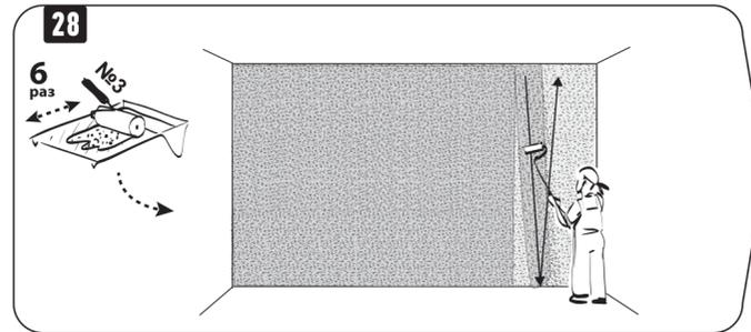
28 Повторяя действия 19-27, нанесите следующую полосу, а затем всю поверхность стены.
